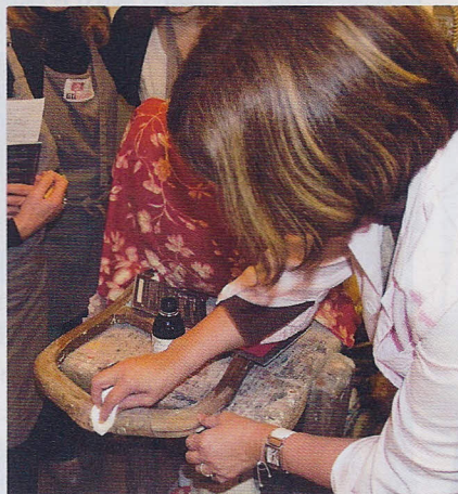
Avant traitement, le bois est nettoyé et dégraissé avec de l'essence de térébenthine.
